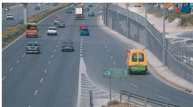
Σχ. 7.5β Αυτοκινητόδρομος με λωρίδα επιταχύνσεως.
