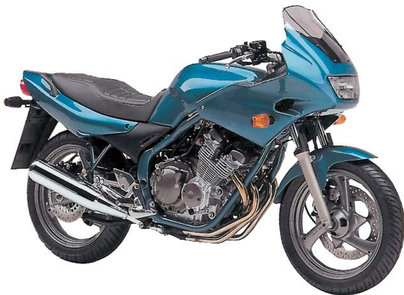
Σχ. 3.5γ Αεροδυναμική κατασκευή προστασίας τουριστικής μοτοσυκλέτας.
