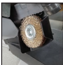
Πίσω οδηγός με βούρτσα καθαρίσματος κορδέλας
