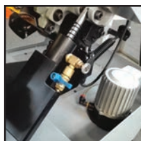
Υδραυλικός κύλινδρος με ρύθμιση ροής
