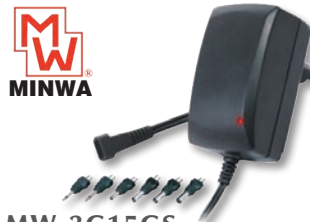
MW-3G15GS €18,00 Σταθεροποιημένο τροφοδοτικό (πακάκι-switching) 24W επιλογή τάσης εξόδου: 9/12/13.5/15VDC 1.5A max, 18/20VDC 1.2A max, 24VDC 1A max
