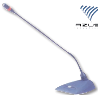
ST-5000 €63,00 Μικρόφωνο τύπου gooseneck, βάση με ενδιεκτικό και πιεστικό ON/OFF. Πυκνωτική κάψα, υπερκαρδιοειδής πολική απόκριση, 80Hz-18KHz, αυξημένη αντοχή στις παρεμβολές από κινητά, μήκος 368mm. Με τάση phantom
