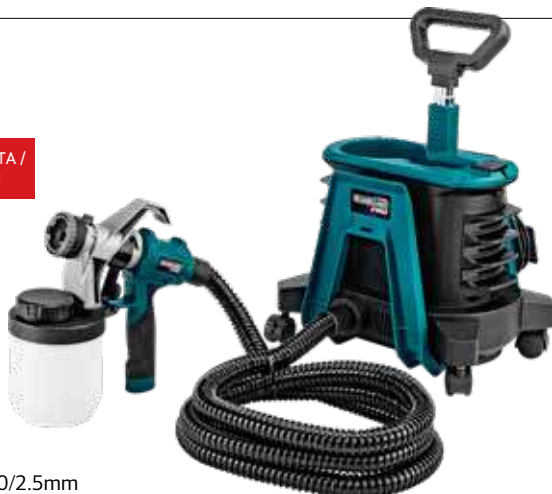
Πιστόλι βαφής • 800W • Μέγιστο ιξώδες 80Din/sec • Παροχή 900ml/min • Δοχείο βαφής 800ml • Ακροφύσιο Ø1.8/2.6mm
