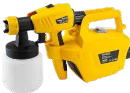
Πιστόλι βαφής • 800W • Μέγιστο ιξώδες 80Din/sec • Παροχή 900ml/min • Δοχείο βαφής 800ml • Ακροφύσιο Ø1.8/2.6mm
