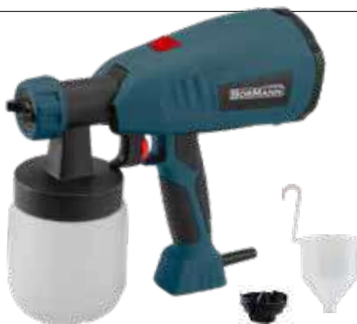
Πιστόλι βαφής • 400W • Μέγιστο ιξώδες 60Din/sec • Παροχή 800ml/min • Δοχείο βαφής 800ml • Ακροφύσιο Ø1.8/2.6mm
