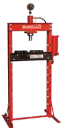
BWR5003 011019 ΥΔΡΑΥΛΙΚΗ ΠΡΕΣΣΑ 20T • Διαδρομή εμβόλου 175mm • Εύρος εργασίας 0-1030mm • 89kg • Διαστάσεις 1550x175x125mm • Με αντλία χειρός
