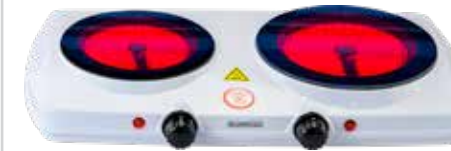
BEP3200 Κεραμική διπλή φορητή • Ισχύς 2.500W • 1 εστία x 18.5cm με ισχύ 1.500W και 1 εστία x 15.5cm με ισχύ 1.000W • 2 διακόπτες και 2 λυχνίες λειτουργίας • 5 βαθμίδες λειτουργίας • Αντιολισθητικά πόδια • Αυτόματη διακοπή λειτουργίας • Ανοξείδωτο περίβλημα • Διάσταση M46,5xΠ25xY8,2cm
