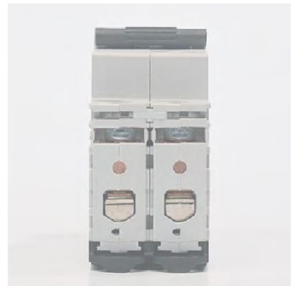
Διατομή καλωδίου εισόδου / εξόδου έως 35mm 2 ή 2x16mm 2
