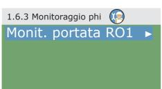
In >Monitoraggio Phi< si può accedere ai menu della portata per i quali si è impostato un sensore di flusso volumetrico.
