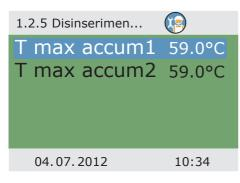
Temperatura massima degli accumulatori 1 e 2. Per evitare che l'acqua nell'accumulatore sia troppo calda, questo viene riempito solo fino al raggiungimento della sua >T max<.
