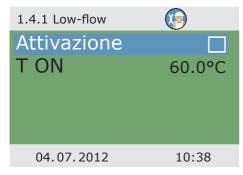
Qui si può determinare la temperatura di inserimento per impianti low-flow.
