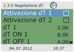
Se in >1.3.7 Parametri uscita< sono stati definiti algoritimi di regolazione con >dT<, qui si possono configurare le relative uscite.
