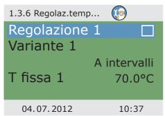
Se in >1.3.7 Parametri uscita< sono stati definiti algoritimi di regolazione con >T fissa<, qui si possono configurare le relative uscite.
