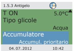
Nel caso di impianti con due accumulatori si deve immettere qui anche da dove provenga il calore antigelo, indicando >Accumulatore prioritario < o >Accumulatore secondario <.
