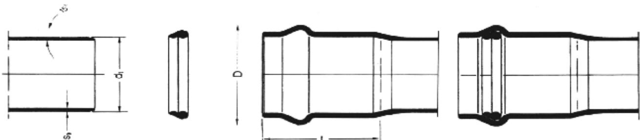
**ΕΛΛΑΣΤΙΚΟΙ ΔΑΚΤΥΛΙΟΙ / O-RINGS FOR FERODUR PIPES**
